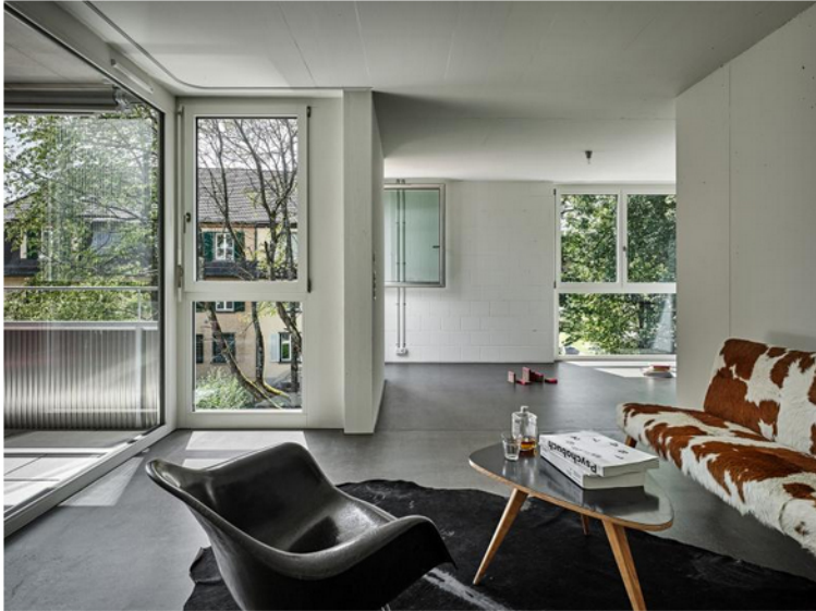
Geschosshohe Fenster in den Raumecken führen zu einem Streiflicht auf den grossen, zusammenhängenden Wandscheiben. Jene werden zu Reflektoren und sorgen für helle Wohnräume. (Foto: Roger Frei)
